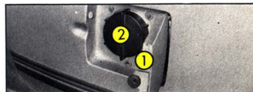
Fig. 6 Orifice réservoir carburant 1 - Volet 2 - Bouchon
