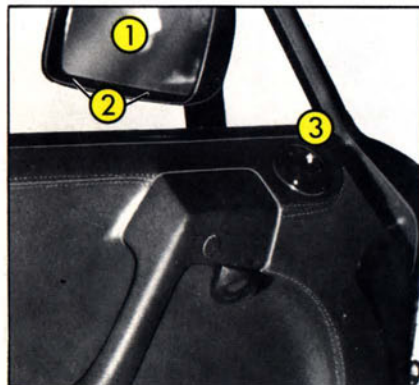
Fig. 10 Rétroviseur extérieur 1 - Miroir 2 - Boîtier 3 - Commande de réglage
