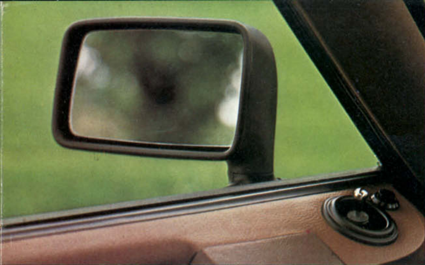
△ Rétroviseur extérieur réglable de l'intérieur par commande mécanique. Verrouillage électrique des portes (option).
