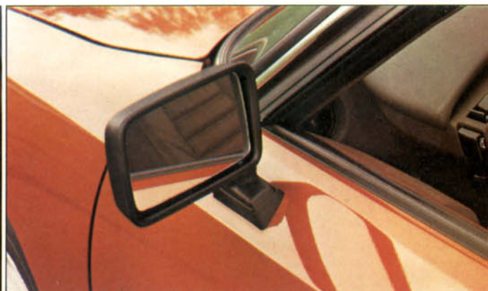
△ Rétroviseur extérieur aérodynamique.
