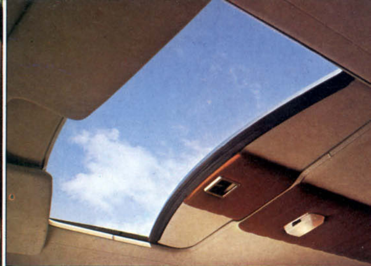
△ Toit ouvrant électrique (option).
