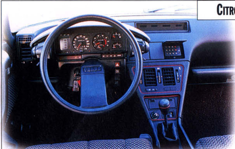
A partir de janvier, un antidémarrage codé est monté sur la CX 25 GTi Turbo 2 au-dessus de la console centrale.
