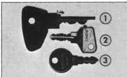
Fig. 1 - Chaves 1 - "Anti-roubo - Contacto e Pré-aquecimento - Motor de arranque" 2 - Portas laterais da frente e mala 3 - Porta-luvas
