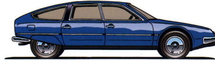
● CX 20 TRE (1983) A partir de septembre 1982, tous les modèles reçoivent de nouvelles ailes avant, à l'arche élargie, pour le montage de pneus plus larges.
